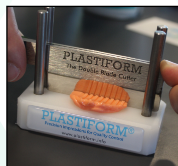
Empreinte externe en P35 coupée au Cutter Double Lame
